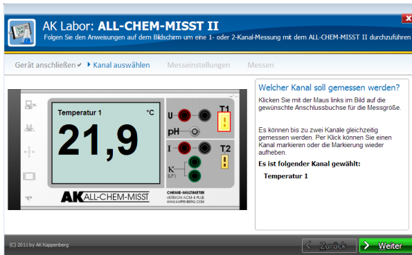
Wahl der Messgröße durch Anklicken oder Einstecken des Fühlers
