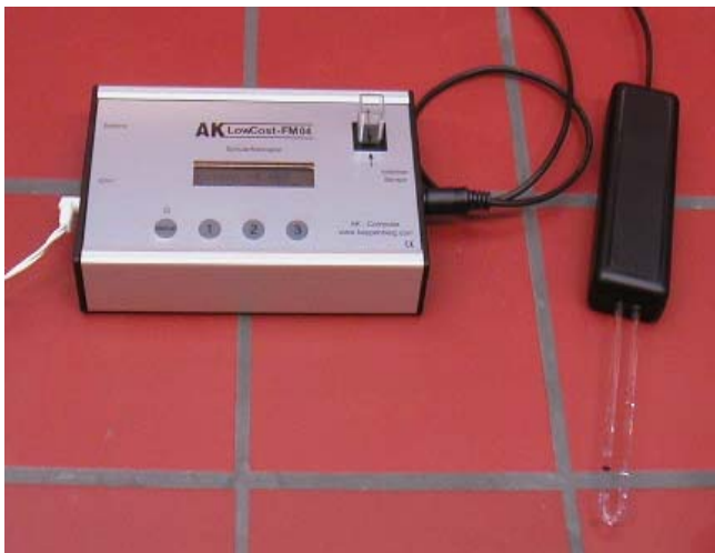
Abbildung des Fotometers mit 10x10 mm Standardküvette und Tauchvorsatz.
