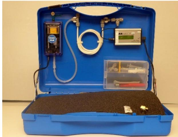
**Lieferung:** Grundmodul plus Aquarienpumpe („OUT“ / „IN“, 150 l/h), WLD- Sensor, 2 Ersatz-Birnchen, „Knacker“ für weitere Gühbirnchen, GC Elektronik 15 für WLD- und Gassensor
