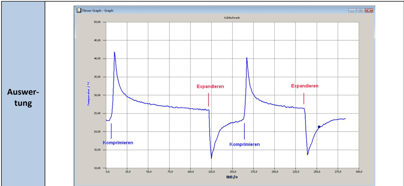
Durch die Kompression des Gases (Kompressorfunktion außerhalb des Kühlschranks) steigt die Temperatur. Nach dem Abkühlen auf Raumtemperatur sinkt durch Vergrößerung des Volumens des Gases (Funktion des Verdampfers im Kühlschrank) die Temperatur.
