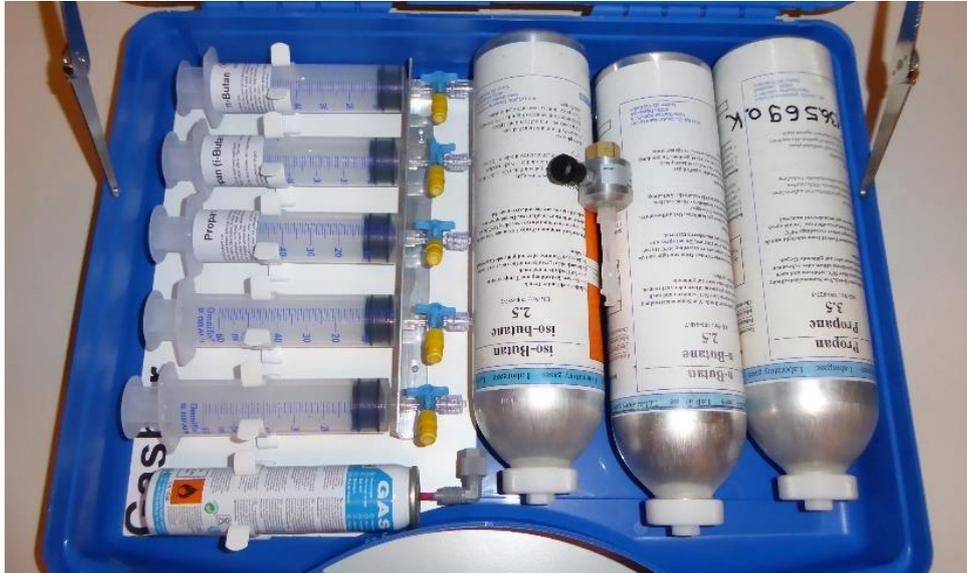
Da die Verschlüsse der sehr teuren Originaldruckdosen sehr empfindlich sind, empfiehlt es sich, dass der Lehrer für die Schüler die Gase in Spritzen mit Entnahmestelle umfüllt. Die Septen befinden sich diesmal im sogenannten Injektstopfen (gelb)
