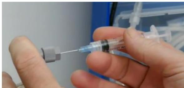
**Achtung:** Die Gasdose steht unter Druck: Mit dem Zeigefinger der linken Hand ganz vorsichtig drücken, sonst fliegt der Stempel aus der Spritze!
